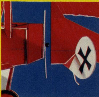
Links: So muß die Schräge des Motorteils aussehen. Rechts: der Lande-Sporn am Rumpfende
